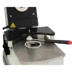
Приспособление для анализа пленок и твердых проб
